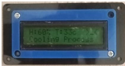
Gambar 9. LCD Alat Pengatur Suhu dan Kelembapan
